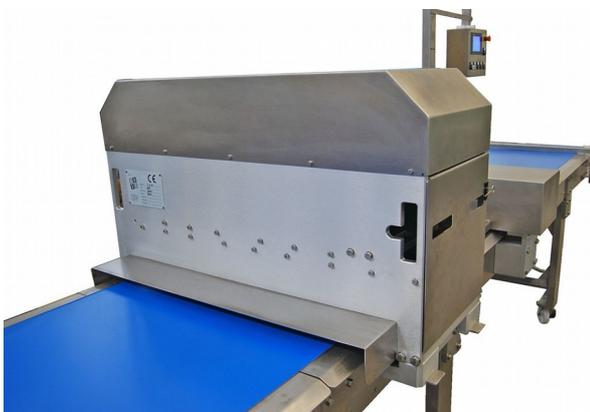
La taglierina a lama è integrabile alla linea di processo, e viene gestita con il software che la sincronizza con l'avanzamento ed il passo del nastro.
